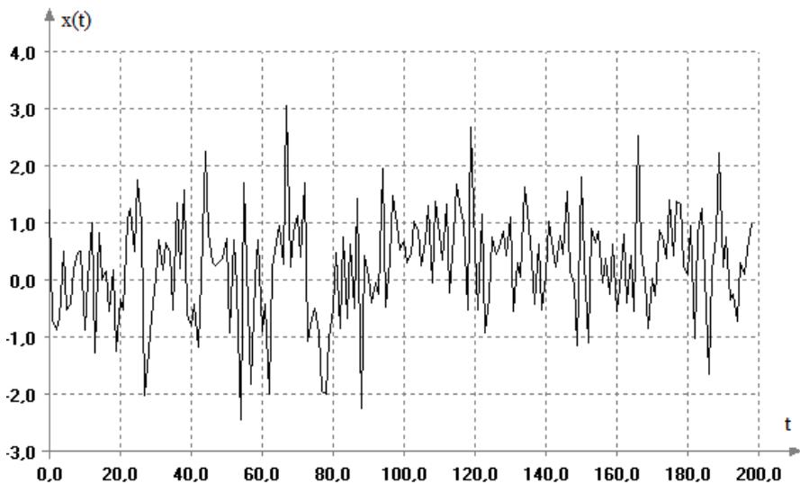
Рис. 3.6. Временной ряд измерений со сдвигом среднего на  $0.5\sigma$
