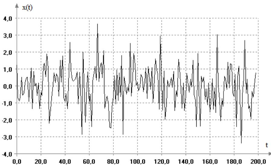
Рис. 5.4. Временной ряд измерений с линейным и периодическим трендом в дисперсии
