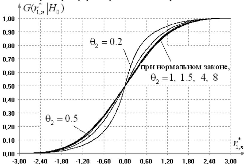
Рис. 2.2. Функции распределения статистики критерия автокорреляции в зависимости от параметра формы семейства (2.3) при  $n = 25$
