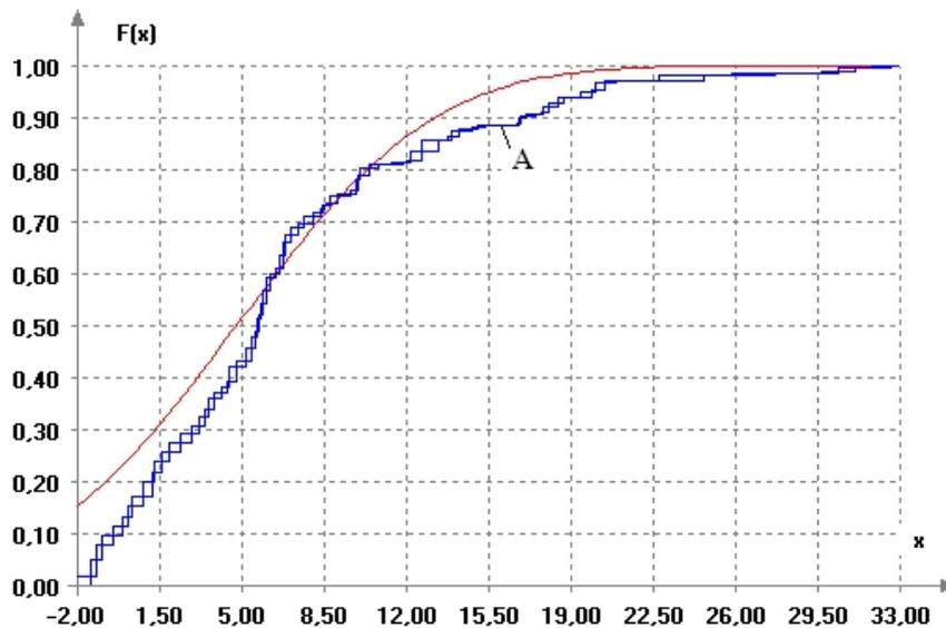
Рис. 7. Эмпирическая функция распределения ГТП ОПФ [(А) для ОПФ от 6698 до 796207] и функция распределения нормального закона с параметрами  $\hat{\mu} = 4.833$ ,  $\hat{\sigma} = 6.602$
