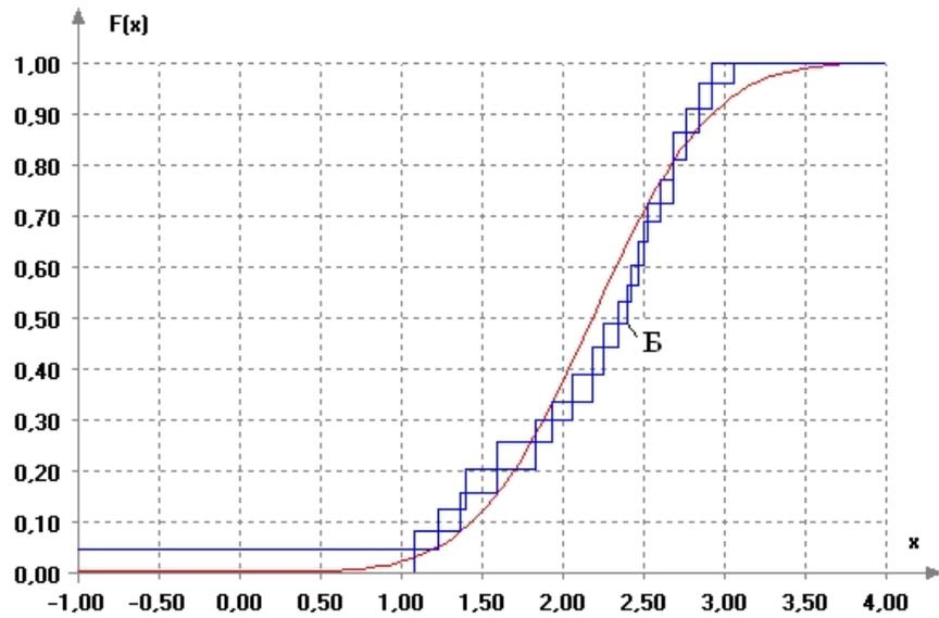
Рис. 11. Эмпирическая функция распределения ГТП ОПФ [(Б) с ОПФ от 1625363 до 2611405] и функция распределения нормального закона с параметрами  $\hat{\mu} = 2.189$ ,  $\hat{\sigma} = 0.578$
