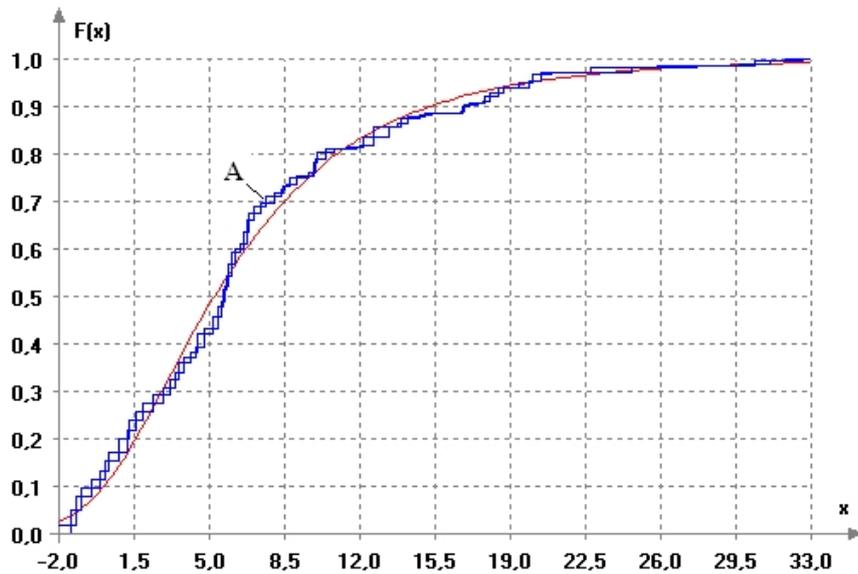
Рис. 9. Эмпирическая функция распределения ГТП ОПФ [(А) для ОПФ от 6698 до 796207] и функция распределения Су-Джонсона с параметрами  $\hat{\theta}_0 = -1.891$ ,  $\hat{\theta}_1 = 1.561$ ,  $\hat{\theta}_2 = 4.555$ ,  $\hat{\theta}_3 = -1.677$
