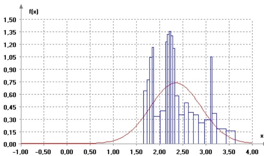
Рис. 16. Гистограмма ГТП ОПФ [(В) с ОПФ от 5922893 до 10118630] и функция плотности нормального закона с параметрами  $\hat{\mu} = 2.348$ ,  $\hat{\sigma} = 0.545$
