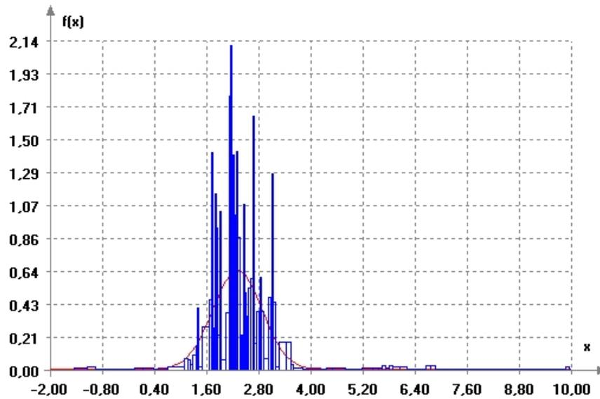
Рис. 22. Гистограмма ГТП ОПФ (полной выборки) и функция плотности смеси 3-х нормальных законов
