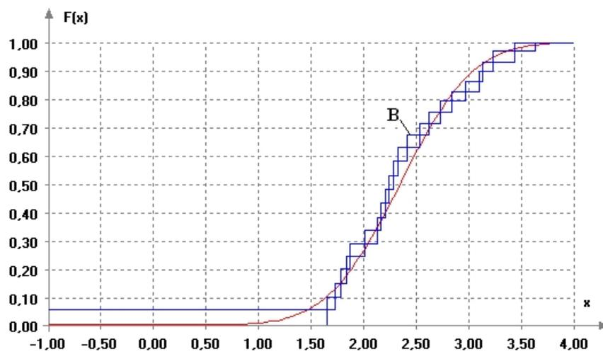
Рис. 15. Эмпирическая функция распределения ГТП ОПФ [(В) с ОПФ от 5922893 до 10118630] и функция распределения нормального закона с параметрами  $\hat{\mu} = 2.348$ ,  $\hat{\sigma} = 0.545$
