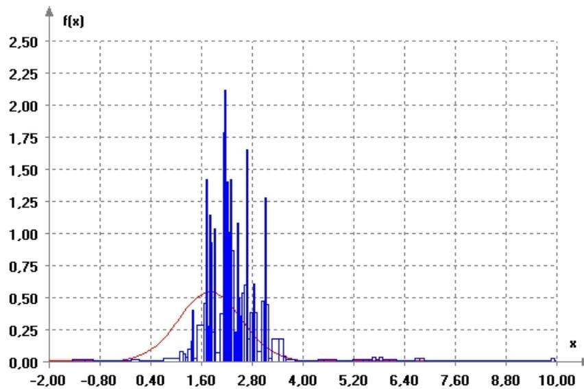
Рис. 2. Гистограмма, построенная по полной выборке ГТП ОПФ США, и функция плотности нормального закона с оценками параметров  $\hat{\mu} = 1.818$ ,  $\hat{\sigma} = 0.756$
