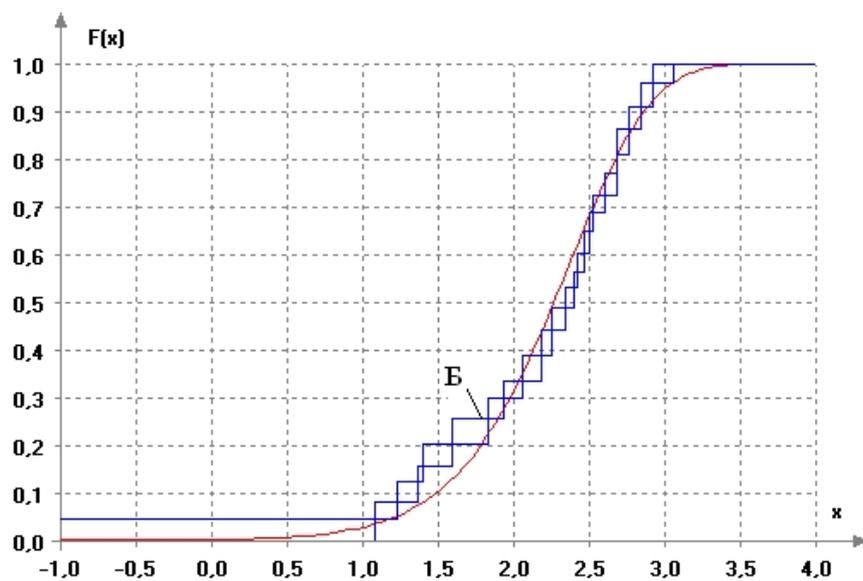
Рис. 13. Эмпирическая функция распределения ГТП ОПФ [(Б) с ОПФ от 1625363 до 2611405] и функция распределения Su-Джонсона с параметрами
